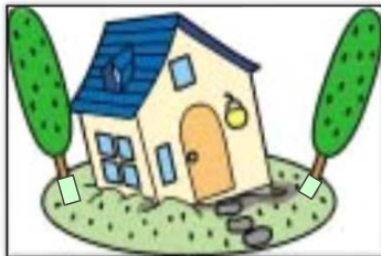
地震による家の沈下・傾斜
