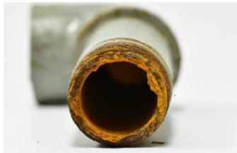
錆びた水道管
